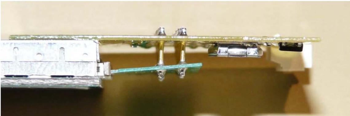
Bild 12.3: Verbindung GPS-Modul mit Trägerplatine
