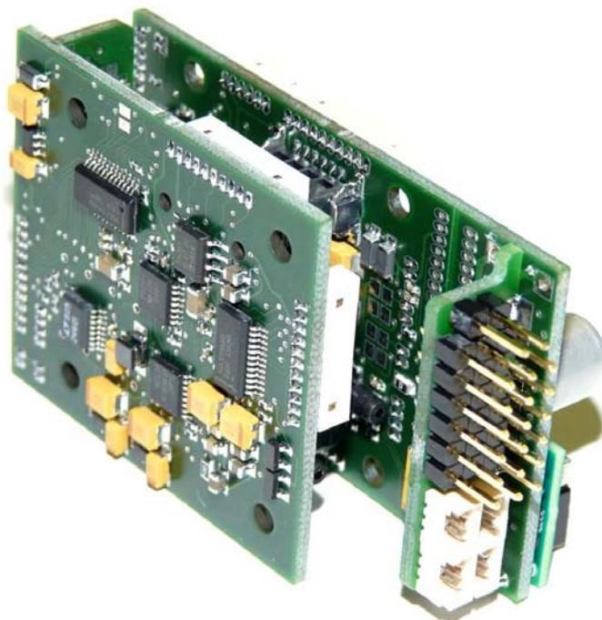
*Bild 11.8: MCU und IMU gesteckt*
