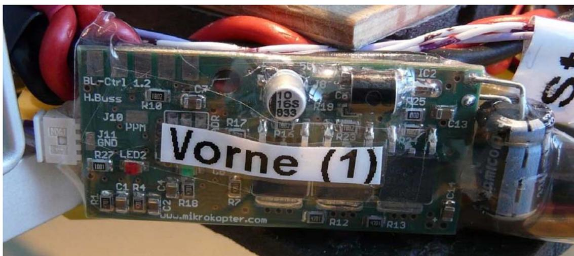
Bild 12.1: Bereits eingeschrumpfter und am Quadrokofter montierter Motorsteller
