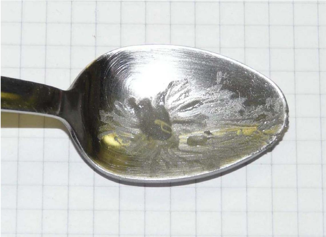
*Bild 10.2: Aufbereitete Lötpaste*
