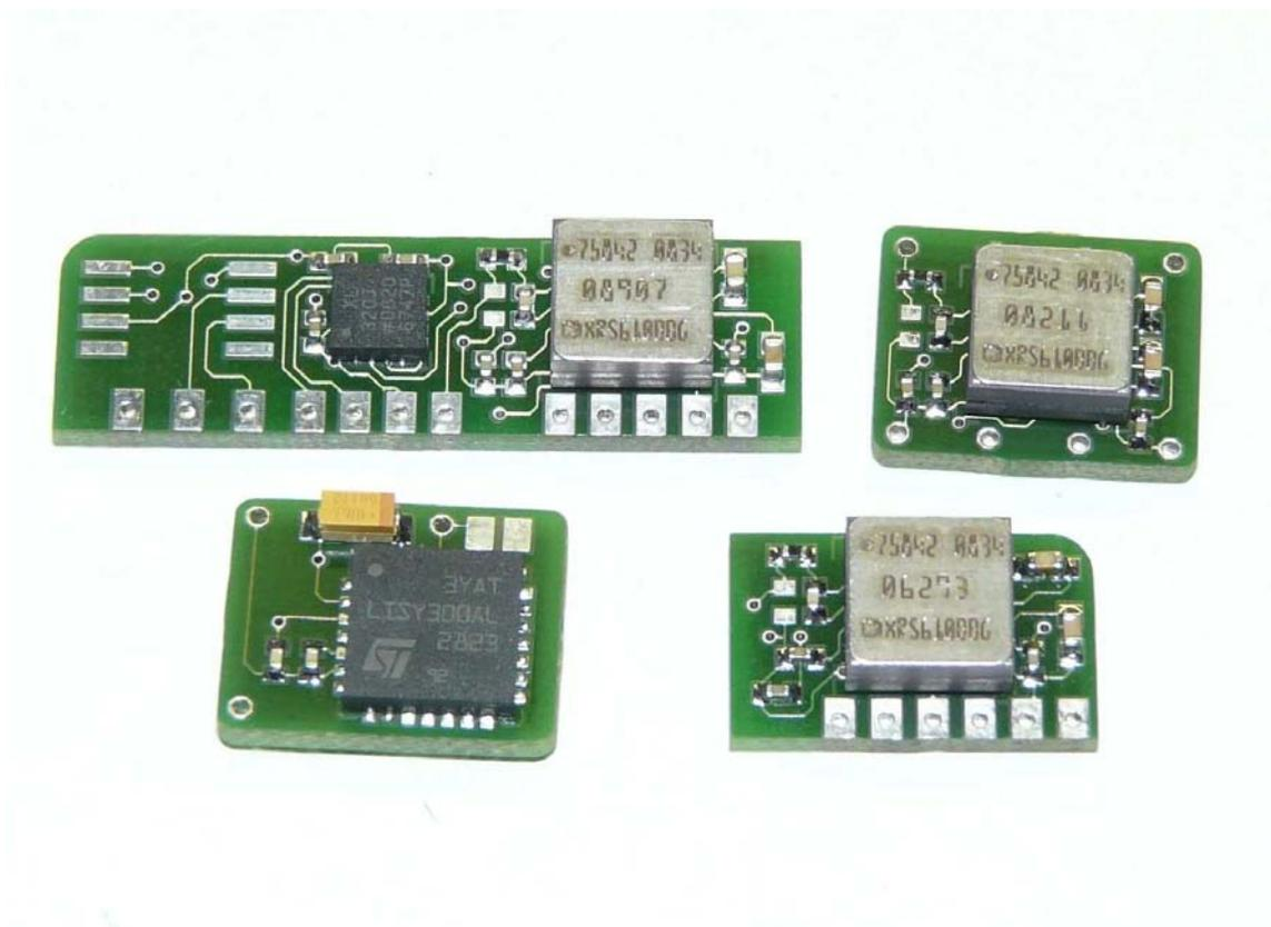
Bild 10.8: Fertig bestückter Sensorplatinensatz
